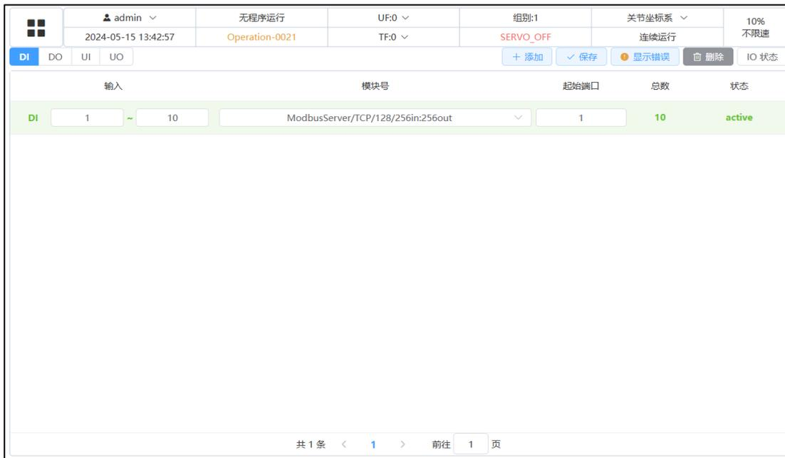
3. DI/DO/UI/UO 添加完成后点击 **IO 状态**，返回 IO 状态控制与监控页面；
